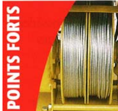
POINTS FORTS Deux câbles indépendants. Charge de rupture 1600 kg chacun. Coefficient de sécurité supérieur à 6.
