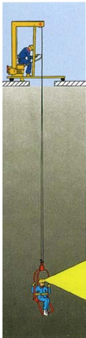
POINTS FORTS Deux câbles indépendants. Charge de rupture 1600 kg chacun. Coefficient de sécurité supérieur à 6.
