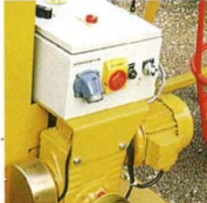
Frein à manque de courant. En cas de panne de courant, le treuil s'immobilise automatiquement freins serrés.
