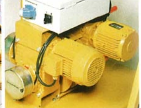
Deux treuils indépendants. Un treuil assure la fonction levage. L'autre : fonction pare-chute. Les deux treuils sont synchronisés.
